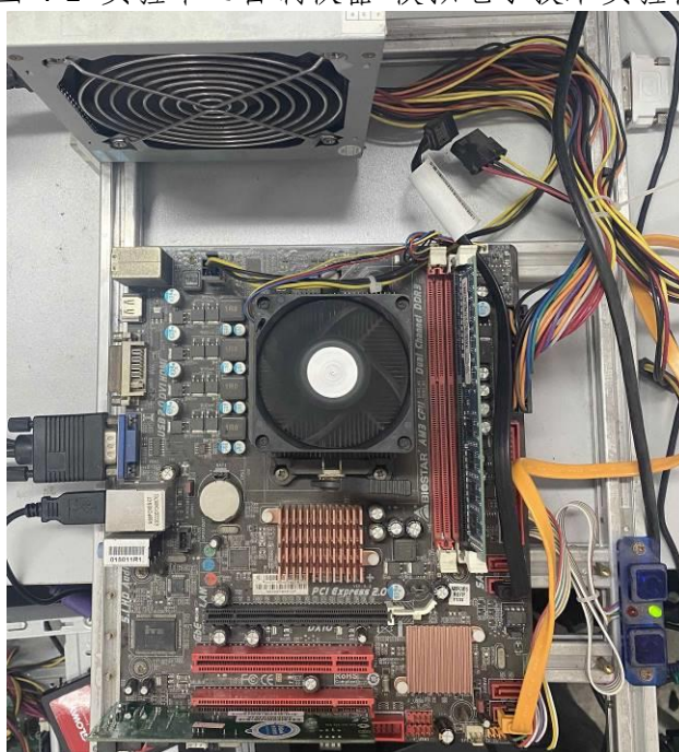
图 4-2 实验中心自制仪器-内存芯片检测平台
